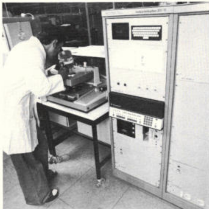
Afb. 11. Laag na laag wordt zo de gewenste schakeling op het basis-materiaal silicium opgebouwd. Na een eerste optische controle m.b.v. de microscoop worden de chips, nog in het waferstadium, getest m.b.v. een speciale computer. We merken in dit verband op dat vrijwel alle testapparatuur door ITT Semiconductors zelf is ontwikkeld en gebouwd.
