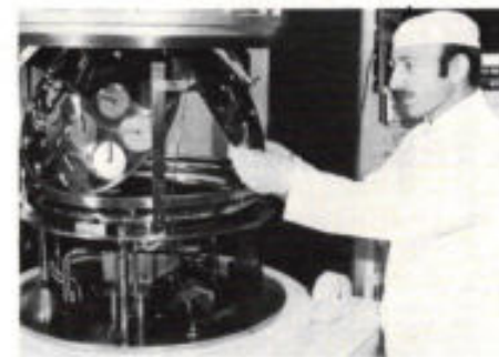
Afb. 4. Hogestroom ionenimplantatie reactor voor de massaproductie van transistoren. Om de basis te implanteren worden 39 2"-plakken gedurende bijvoorbeeld 15 minuten blootgesteld aan een sterke ionenstroom (ca. 500 \mu\text{A} ) van een bepaald doteermateriaal.
