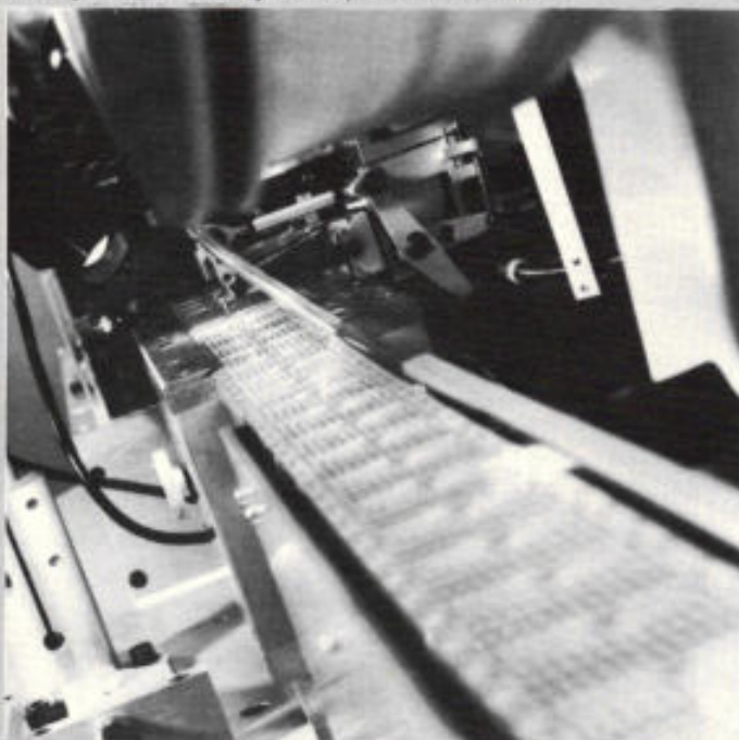
Afb. 14. De goede chips worden nu op een door de machine komende metaalband gelijmd, een band die later de basis vormt voor de chipbehuizingen. Op de foto zijn de IC-pennen al zichtbaar.
