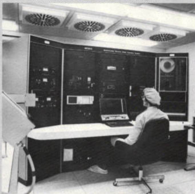
Afb. 6. De magneetband met de maskerinformatie wordt nu overgebracht naar de — zeer schone — ruimte waarin de elektronenstraal-lithograaf is opgesteld. Het elektronenkanon wordt bestuurd door een computer en „brandt“ a.h.w. de informatie in de maskers, schijven zeer zuiver glas met een laagje nikkel. In de ruimte waarin deze apparatuur staat opgesteld mogen max. 500 stofdeeltjes per kubieke meter lucht voorkomen; normale lucht is ca. 1000 x „stoffiger“.
