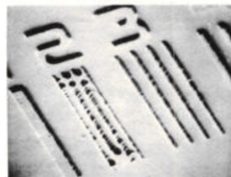
Afb. 3b. Hetzelfde patroon als in afb. 3a, echter natchemisch geëts. Er treedt sterke onderetsing op, bovendien ontstaan als gevolg van blaasvorming doorverbindingen, duidelijk te onderscheiden in het 2 \mu\text{m} -patroon (tweede van links).
