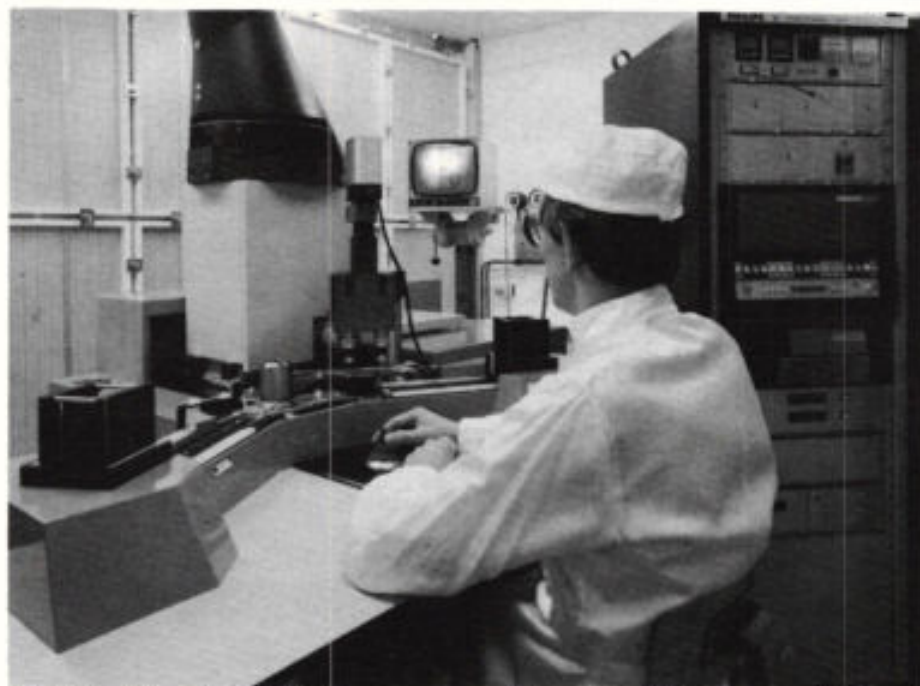
Afb. 8. De „Silicon Repeater“ is een apparaat voor het na elkaar belichten van een silicium-plak met meerdere uiterst nauwkeurig gejusteerde maskers. In dit geval wordt het masker gejusteerd met behulp van een laser interferometrie.
