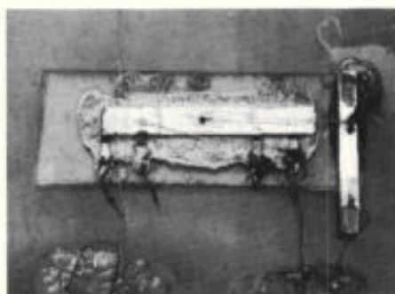
Het eerste „IC“ bevatte een transistor, drie weerstanden en een condensator. Lengte: 1,11 cm.
