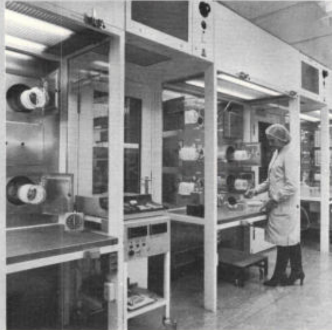
Afb. 10. Op die plaatsen kunnen nu, in het basismateriaal silicium, verontreinigingsatomen worden ingebracht. Dat kan op twee manieren gebeuren: m.b.v. diffusieprocessen bij temperaturen van 1000 \dots 1200^\circ\text{C} (zie foto) of volgens de ionen-implantatiemethode, waarbij ionen met hoge snelheid in het silicium worden geschoten (versnellingspanning: 200 kV). Bij ITT Semiconductors past men op het ogenblik beide methoden toe.
