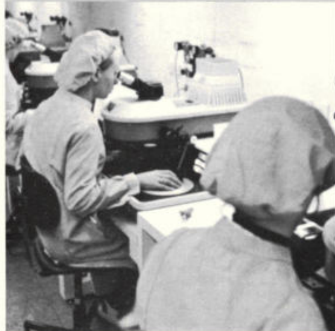
Afb. 9. In zeer zuivere ruimten met een UV-belichting worden de structuren van een masker op fotolithografische wijze overgebracht op de siliciumwafer, die daartoe is voorzien van een fotogevoelige laag (dikte 1 \mu\text{m} , \pm 5\% ). Na ontwikkelen van deze laag worden de niet-belichte plaatsen weggeëtst.
