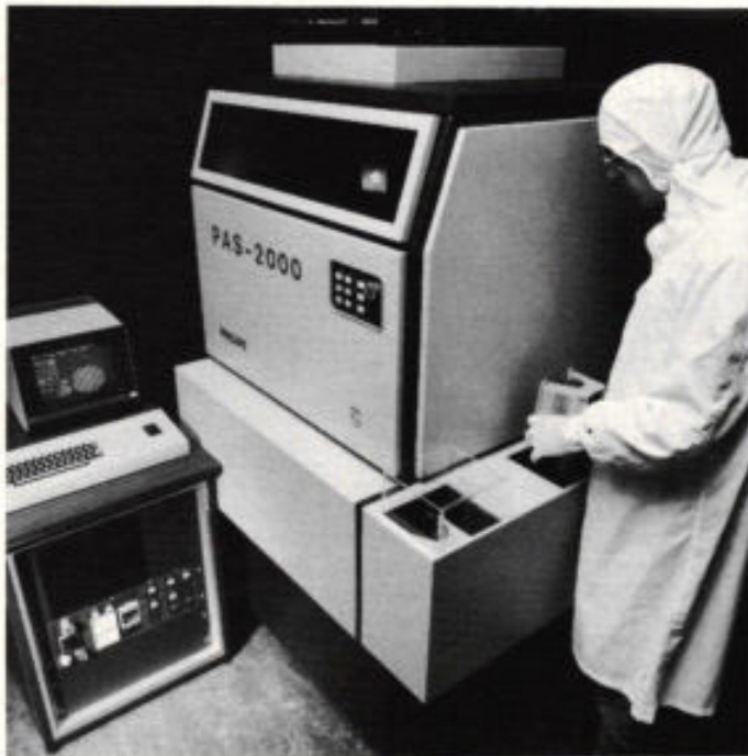
Het klinisch exterieur van dit apparaat herbergt een waferstepper waarmee maskerpatronen door belichting op de siliciumschijf worden afgebeeld met een snelheid van ca. 200 stappen per minuut. Met de installatie zijn structuren van ca. 1,5 \mu\text{m} te verwezenlijken, wat de uiterste met lichtafbeelding te bereiken grenzen nadert (foto Philips).
