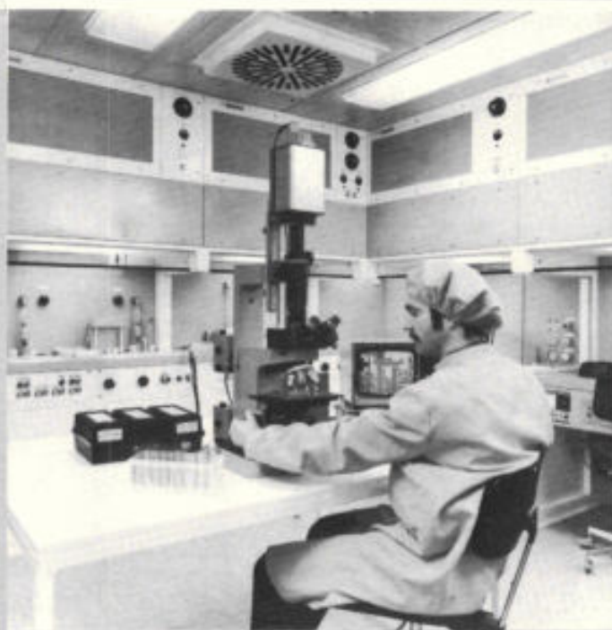
Afb. 8. Zelfs dergelijke dure apparatuur is niet helemaal te vertrouwen; een optische controle van de maskers is noodzakelijk, gebruik makend van een microscoop, een videocamera en een beeldscherm waarvan de beeldgrootte is gekalibreerd in aantallen micrometers. Een behoorlijk tijdrovende procedure natuurlijk, vooral als we bedenken dat voor één chip soms 10 maskers nodig zijn.
