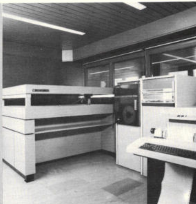
Afb. 4. De Prime-computer levert tenslotte een magneetband die alle structuren van de chip in-spié bevat. Met behulp van de informatie op deze magneetband wordt een immense tekentafel gestuurd die het chipontwerp, weer in verschillende kleuren, op papier weergeeft.
