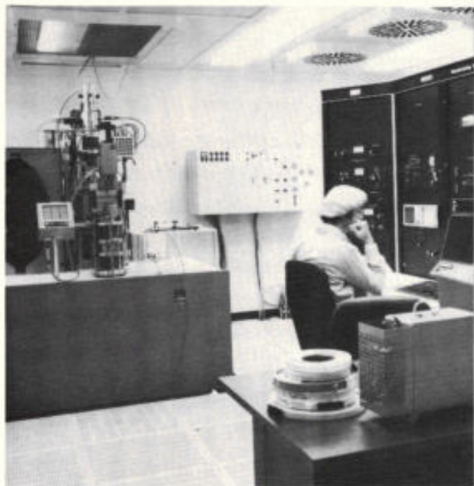
Afb. 7. Links op deze foto het elektronenkanon. Het oplossend vermogen van de E-beam is 0,12 \mu\text{m} , en op één masker worden, afhankelijk van de chip- en wafergrootte, 100 tot soms meer dan 1000 chip-structuren tegelijkertijd aangebracht.
